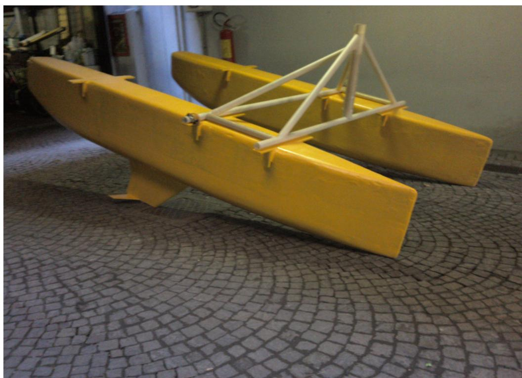
Primo posizionamento del traliccio di prua che compie le funzioni di doppia traversa anteriore e di supporto per l'albero non insartiato.
