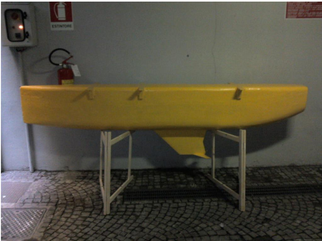
Qui e' stata inserita la deriva fissa, e' stata completata la resinatura ed e' stata completata la verniciatura con smalto lucido all'acqua.
