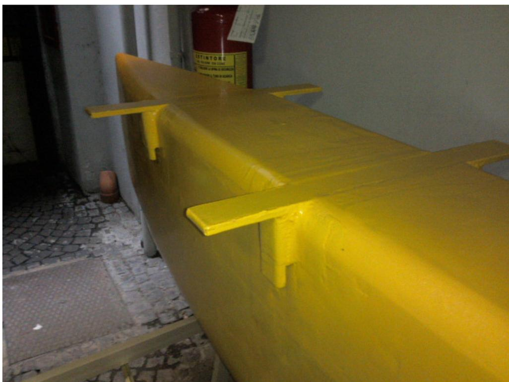
Particolare degli irrobustimenti necessari al fissaggio delle traverse.
