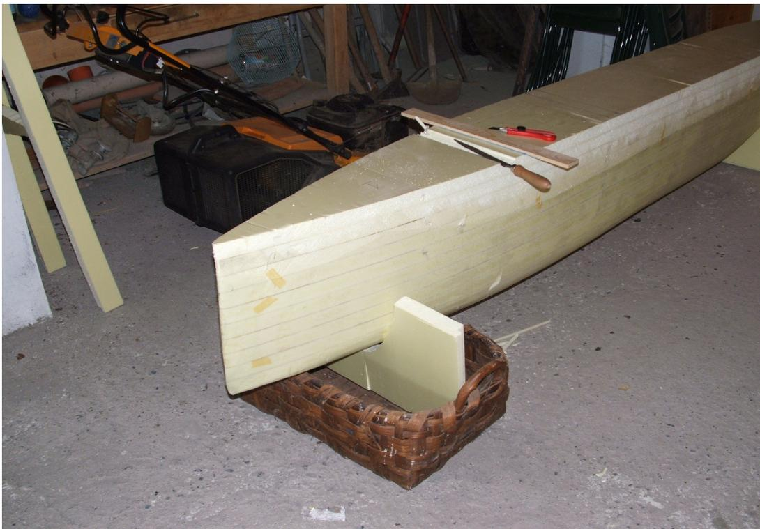
E' stata completata la resinatura del primo strato, lo scafo e' stato raddrizzato e si procede a disporre gli appoggi per le traverse.
