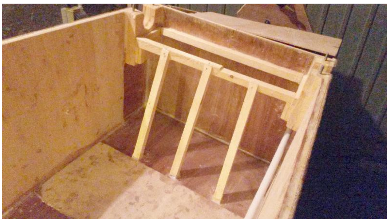
Vista dei rinforzi dello schienale prima della chiusura
