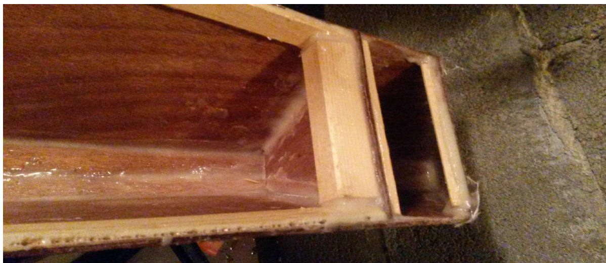
paratia in compensato a 15 cm da poppa con il listelli rispettivamente 20x20 mm (a sinistra) e 20x5 mm (a destra) della paratia. Listello da 20x5 mm anche sullo specchio di poppa. vista totale:
