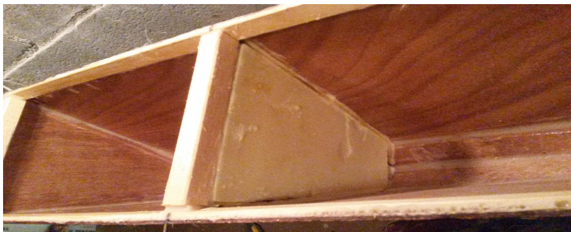
paratia in polistirene tra le due paratie in compensato a 60 cm e 140 cm da prua con listello superiore 20x20 mm
