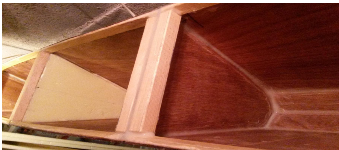
paratia in compensato a 140 cm da prua con i due listelli superiori 20x20 mm paratia in polistirene tra le due paratie in compensato a 140 cm da prua e 15 cm da poppa con listello superiore 20x20 mm
